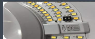
El switch incorporado en el equipo permite el cambio de temperatura de color, en una única referencia.
