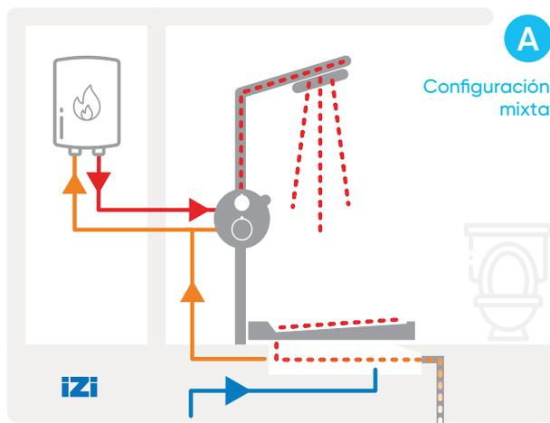
A. El agua precalentada se transfiere al grifo y al calentador. La configuración más eficiente.
